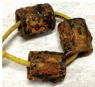
Après essai au brouillard salin (720 h)
